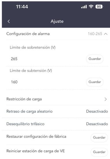
Figura 8-22 Configuración de alarma
