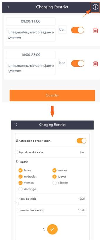
Figura 9-24 Establecer un nuevo período de restricción de carga
