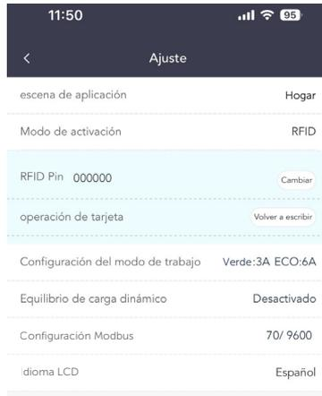
Figura 9-5 Introducir un nuevo PIN RFID y guardarlo
