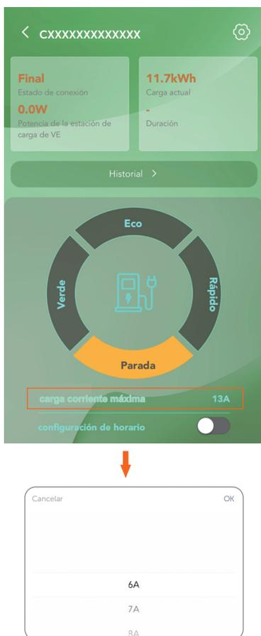
Figura 9-29 Configuración de la corriente de carga máxima
