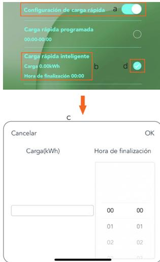
Figura 9-15 Configuración de carga rápida inteligente
