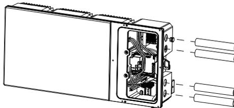
Figure 5-4 Install conduits
