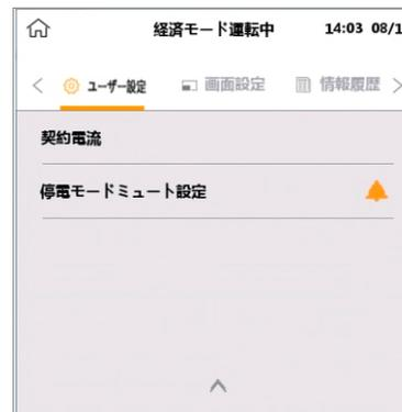
電力会社との契約電流が変更になった場合は、契約電流の設定を変更してください。契約電流は、必ず電力会社と契約しているアンペア数に合わせて設定してください。間違えて設定すると、主分電盤のブレーカーの誤動作や、蓄電池の充放電に、悪影響を及ぼす可能性がありますので、ご注意ください。
