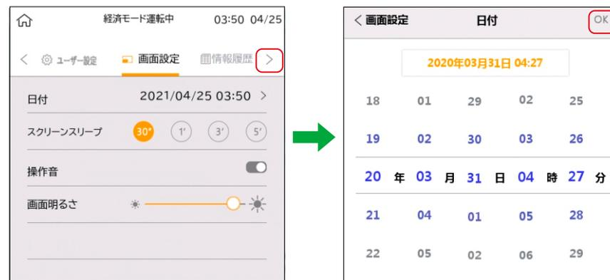
日時の右側の > を押すと、時間設定画面が表示されます。中央ボックス内に、目的の時間にカーソルを合わせ、日時を設定してください。設定が完了したら、右上の【OK】を押して、時間設定を完了させてください。
