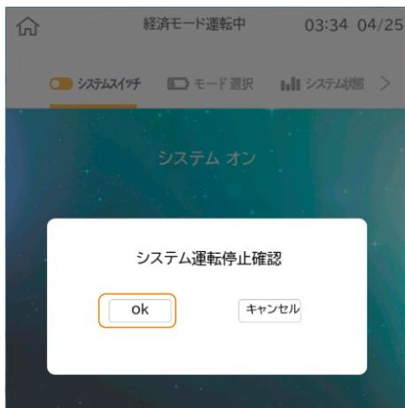
システム運行を停止したい場合、システム・オフを押して、「システム運行停止確認」の画面がポップアップします。「OK」を押すと、システム運行を停止します。
