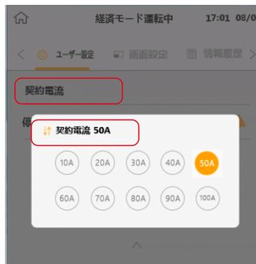
設定方法：「契約電流」をタッチして、設定画面に入ります。「契約電流10A」は、現在設定されている契約電流が、10アンペアであることを表示しています。この表示画面にて、新たに契約された契約電流のボタンを選択して、設定を完了させて下さい
