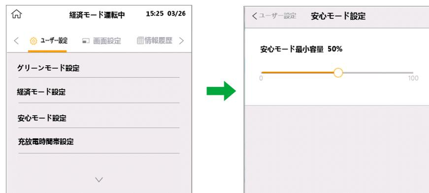
電池のSOC（電池蓄電容量の制限値）を設定することができます。円形のボタンを押しながら、左右に移動させ、蓄電容量のパーセンテージを調整します。SOCの初期設定値は、50%となっております。調整可能範囲は、30%から100%になります。例えば、初期設定値50%の場合、蓄電残量が50%になるまでは、太陽光発電の発電電力やご家庭の消費電力に合わせて放電し、蓄電残量が50%になると放電を停止します。放電停止後、蓄電池ユニットは充放電時刻設定で設定した充電時間帯になるまで待機状態になります。
