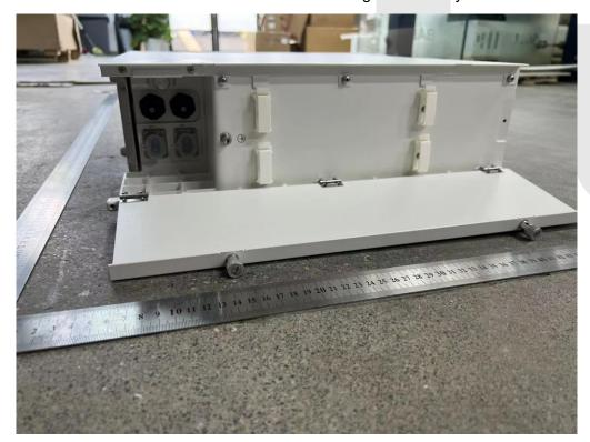
图 4 可充电锂离子电池模组充放电口和通讯口
