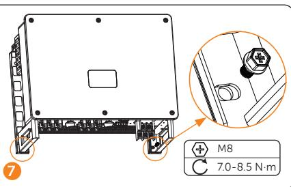
PE Connection / Schutzerdungs-Anschluss / Connexion PE / Conexión PE / Ligação à Terra / PE-aansluiting / Collegamento PE / Połączenie PE / PE připojení / PE-anslutning / Conexiune PE / PE връзка (земя) / Jordforbindelse / Σύνδεση PE / PE ühendus / PE-yhteys / PE priključak / PE bekötés / PE (apsauginio įžeminimo) kontaktas / PE savienojums / Prijenie ochranného vodiča / PE povezava / PE Bağlantısı / Conexão PE
