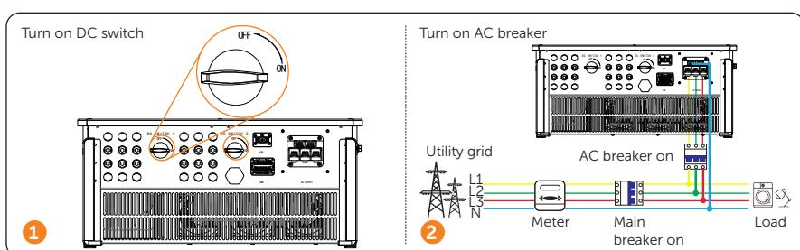
Lockable DC Switch / Abschließbarer DC-Schalter / Interrupteur CC verrouillable /
